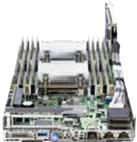
HPE ProLiant XL190r Gen9 mit Intel® Xeon® Prozessor der ES-2600 v3 Serie
